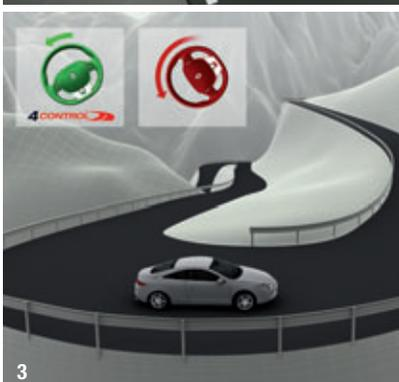
2. Über 60 km/h schlagen die Räder hinten in der gleichen Richtung wie die Vorderräder ein. Die Lenkunterstützung durch das Fahrzeugheck wirkt den auftretenden Fliehkräften wirkungsvoll entgegen und ermöglicht höhere Kurvengeschwindigkeiten bei stabiler Straßenlage.
