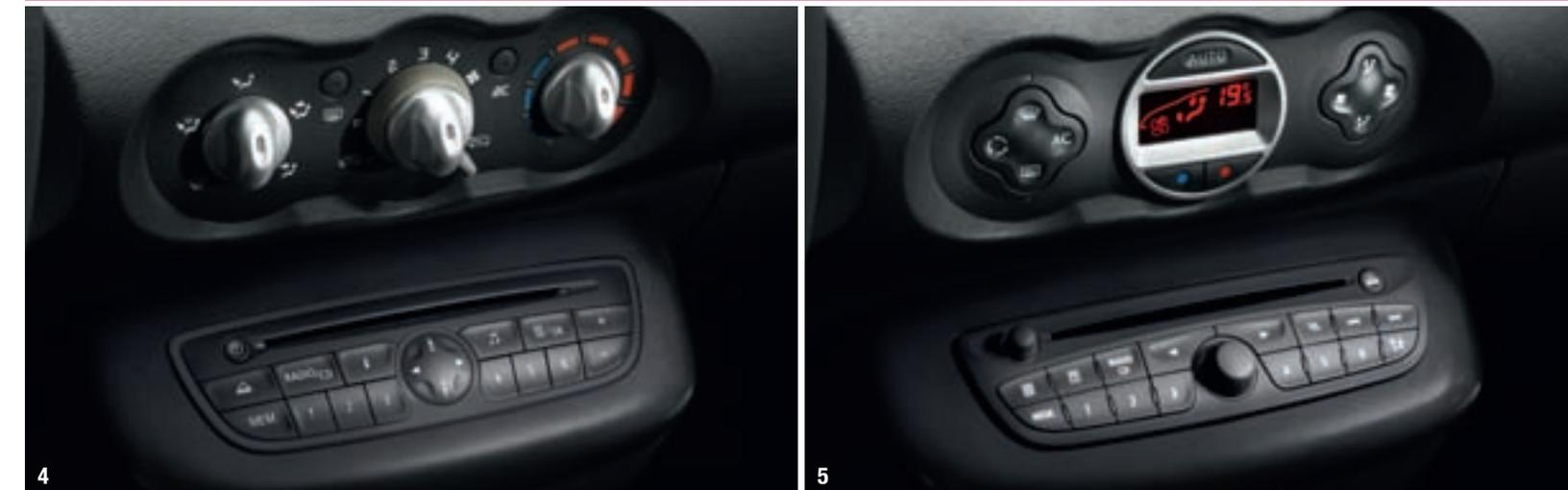
**4. RADIO 4 x 15 W CD MP3** mit AUX-IN über CINCH-Stecker und separatem Display.
