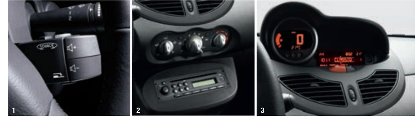
**1. BEDIENUNGSATTELLIT AM LENKRAD**
