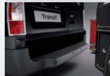
Park-Pilot-System, hinten Inklusive einer in den Stoßfänger integrierten Trittstufe hinten.
