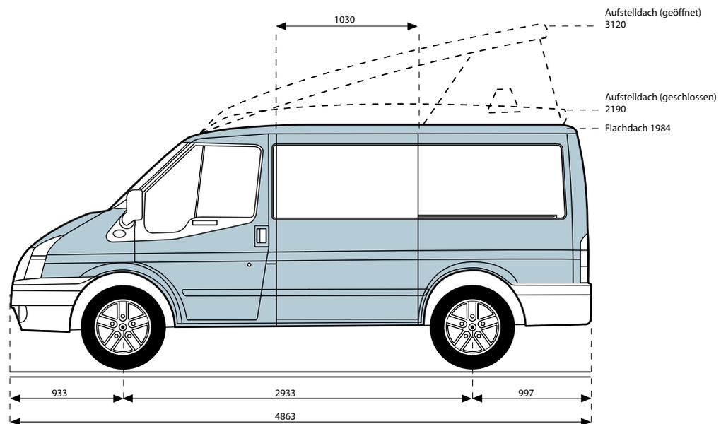
Abmessungen in mm, Ford Transit Euroline, kurzer Radstand
